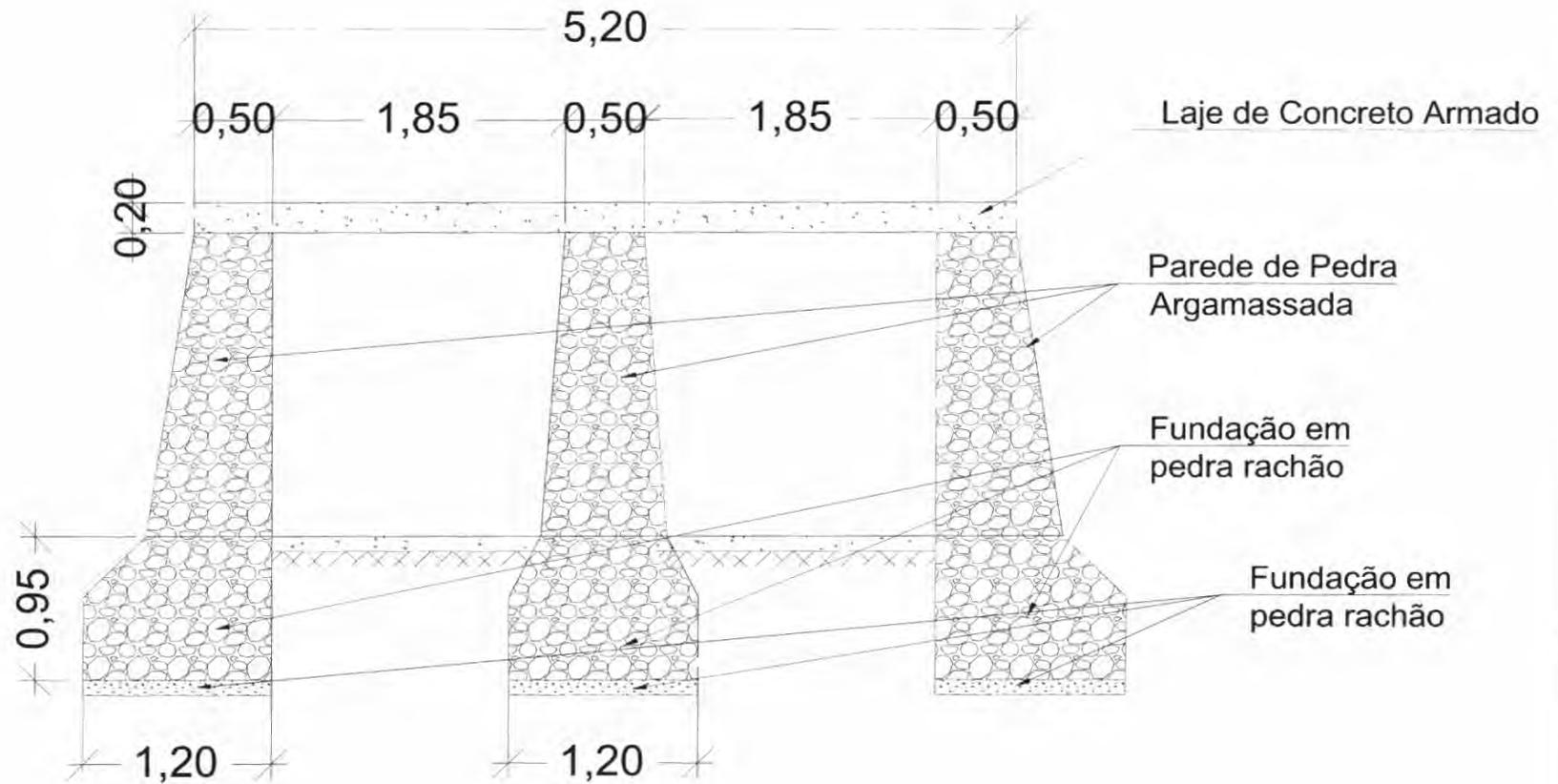
BUEIROS DUPLOS CELULARES DE CONCRETO CICLOPICO COM LAJE E VIGAS DE CONCRETO ARMADO
